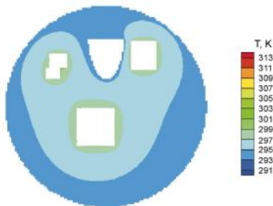
Рис. 17. Распределение температуры в сечении С-С в момент времени t = 160,0 часов
