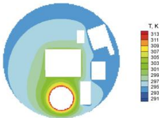
Рис. 18. Распределение температуры в сечении Е-Е в момент времени t = 160,0 часов
