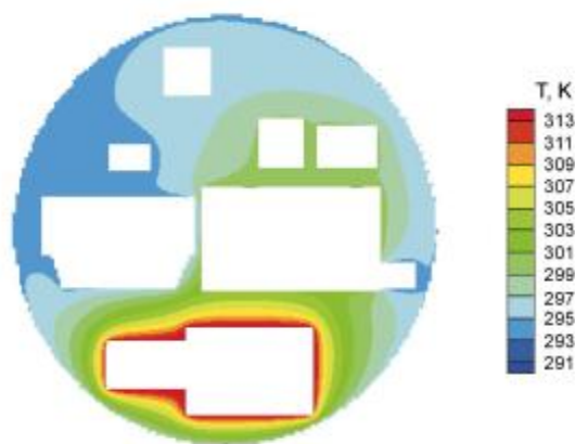
Рис. 16. Распределение температуры в сечении В-В в момент времени t = 160,0 часов
