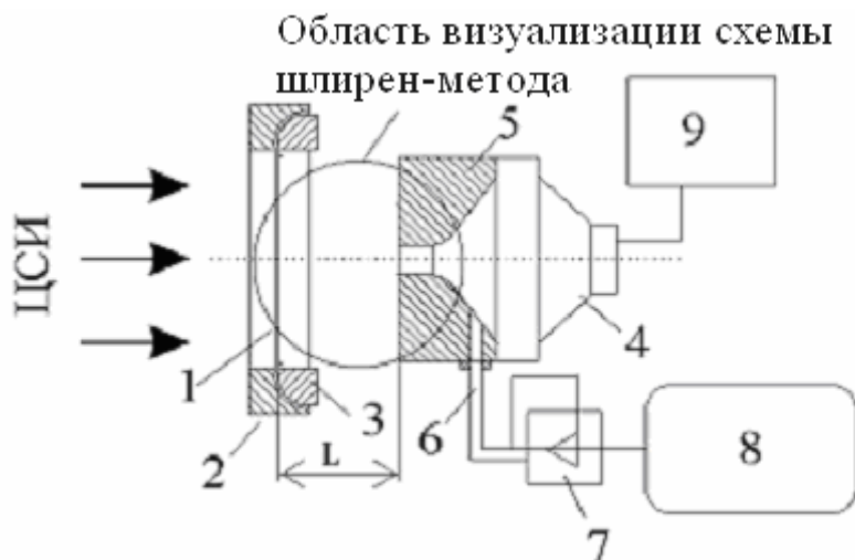
Рис. 2. Схема экспериментальной установки: 1 - мембрана; 2 - корпус; 3 - прижимное кольцо; 4 - звуковой динамик; 5 - формирователь потока; 6 - подводная трубка; 7 - редуктор; 8 - баллон; 9 - звуковой генератор
