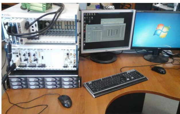
Рис. 1. Наземный отладочный комплекс бортовой электронной аппаратуры космических аппаратов
