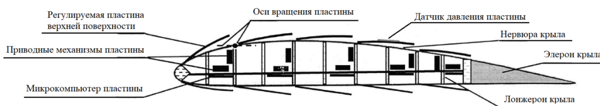
Рис. 20. Конструкция крыла с локально изменяемой кривизной профиля
