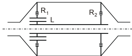
Рис. 5. Схема гасителя колебаний давления с регулируемыми параметрами
