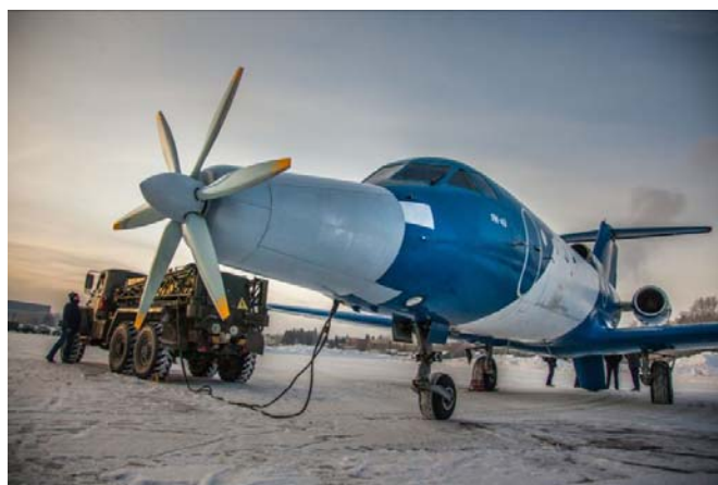
Рис. 5. Процесс испытаний гибридной силовой установки самолёта Як-40
