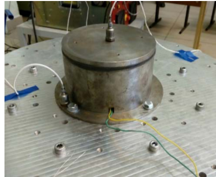
Рис. 6. Экспериментальный стенд для исследования собственной частоты демпфера
