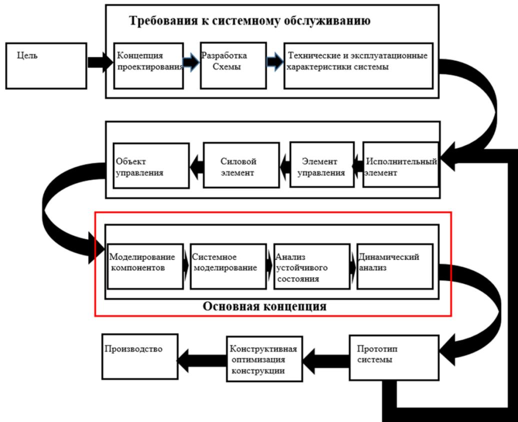
Рис. 1. Процесс проектирования и анализа гидромеханических систем
