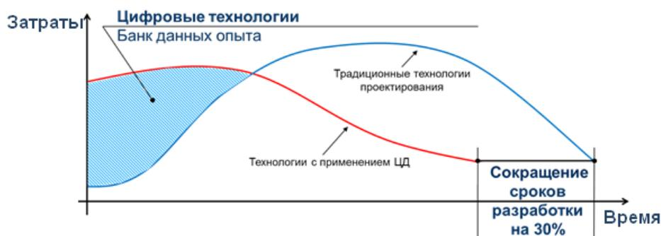
Рис. 4. Трансформация системы разработки при использовании концепции цифрового двойника
