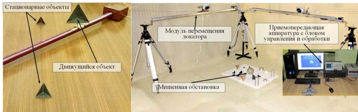
Рис. 5. Внешний вид локационного акустического комплекса
