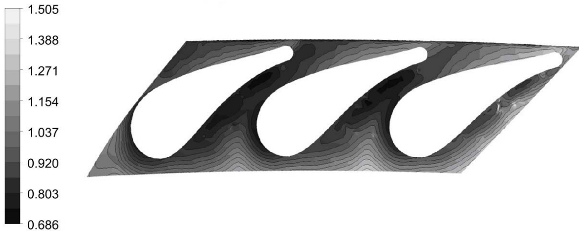
Рис. 3. Относительная эффективность конвективного струйного (душевого) охлаждения при конвективно-плёночном охлаждении
