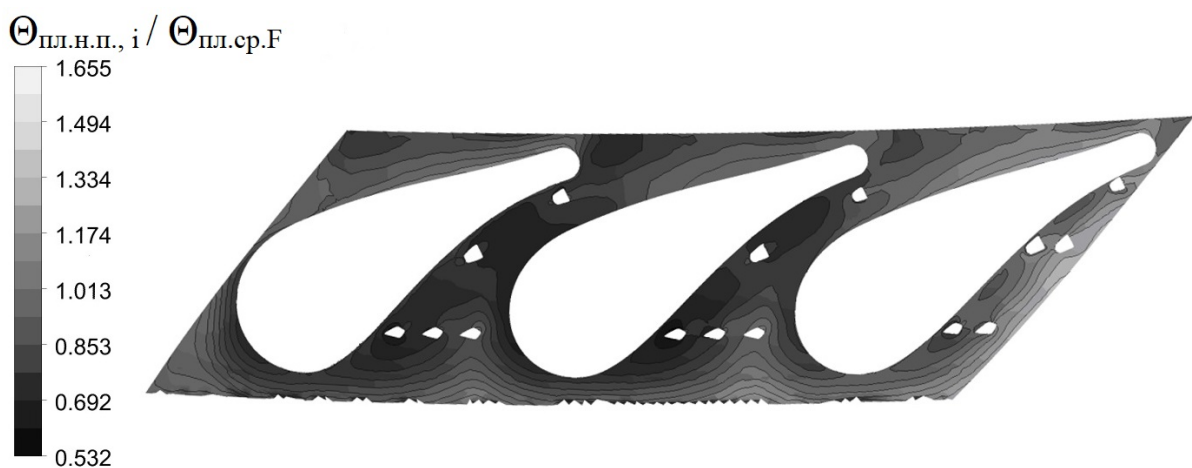
Рис. 6. Относительная эффективность дополнительного плёночного охлаждения при конвективно-плёночном охлаждении
