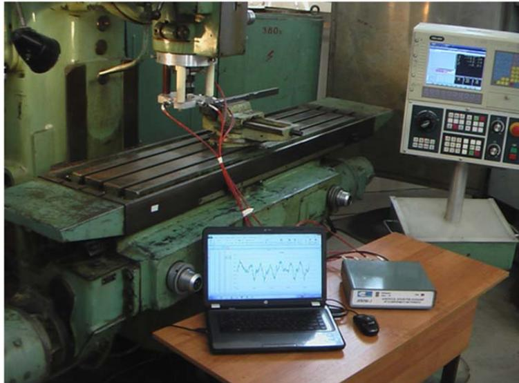
Рис. 3. Общий вид системы для виброизмерений
