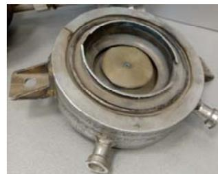
Рис. 1. Двухкомпонентный ракетный двигатель малой тяги ЭД-200-1:
