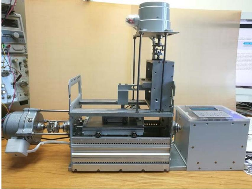
Рис. 1. Внешний вид скретч-тестера СТ-01
