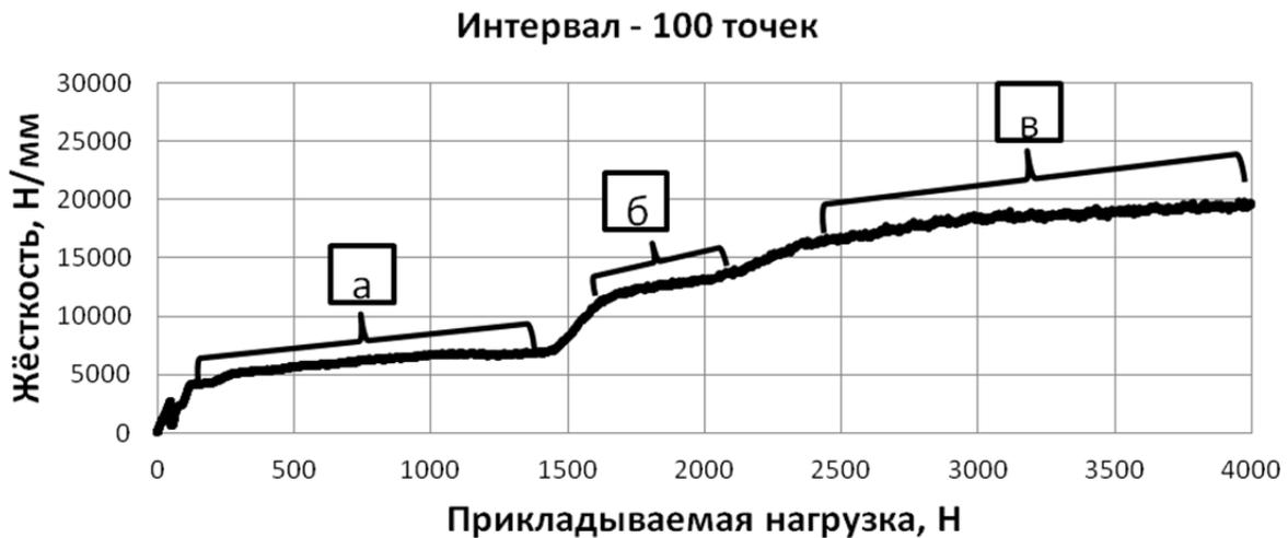
Рис. 8. Зависимость жёсткости упругого кольца от нагрузки
