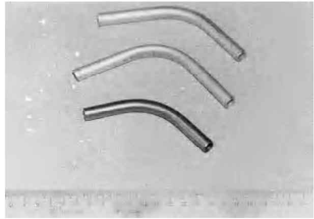
Рис. 8. Образцы изогнутых труб, полученные вдавливанием
