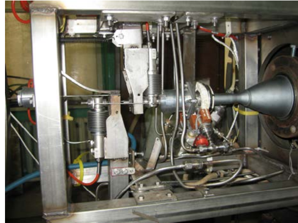
Рис. 3. Общий вид тягоизмерительного устройства с ЖРДМТ
