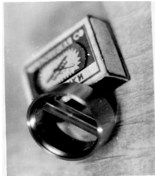
Рис. 2. Внешний вид экспериментальной вставки с пластиной из полиметилметакрилата
