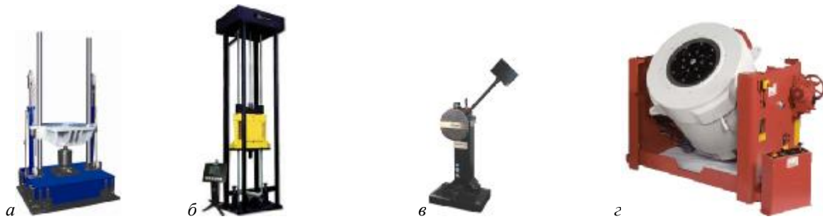
Рис. 1. Ударные стелды: а – тормозящий ударный стелд; б – копр вертикальный; в – копр маятниковый; г – электродинамический стелд
