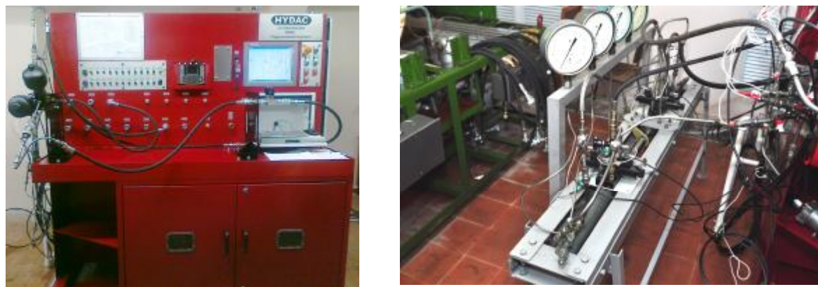
а б Рис. 2. Внешний вид стенда для проведения испытаний гидропривода с дискретным регулятором потока и инерционной трубкой (а) и нагрузочного модуля (б)
