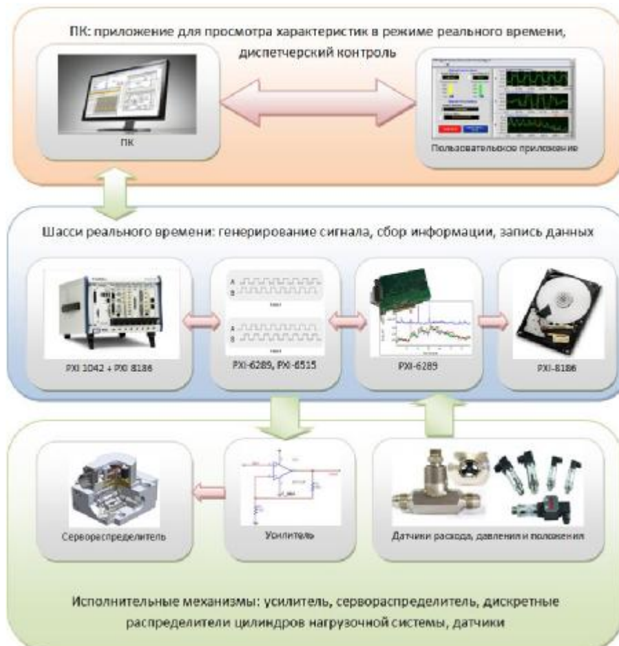
Рис. 4. Структура программно-аппаратного комплекса управления стендом и сбора информации
