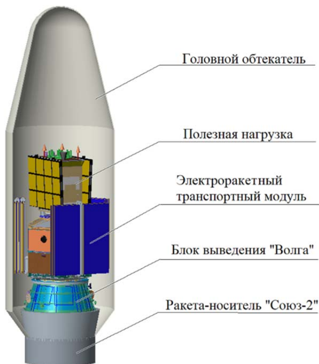
Рис. 2. Состав космической транспортной системы с КА «Глонасс-К1»
