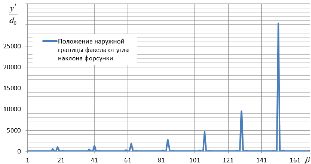
Рис. 4. Зависимость положения наружной границы факела от угла наклона форсунки в диапазоне от 1 до 170°
