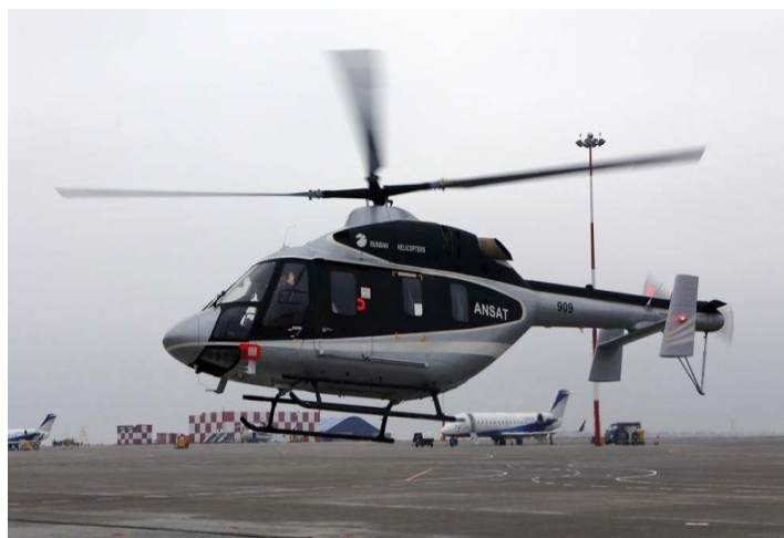
Рис. 2. Ансат ( H_{\text{н}} = 2,9 \text{ км} , v_{\text{max}} = 275 \text{ км/ч} , M_0 = 3,3 \text{ т} , L_{\text{н}} = 510 \text{ км} ) [28]
