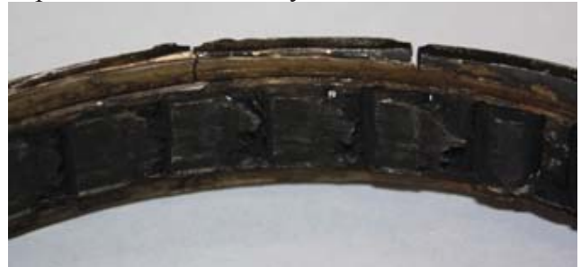
Рис. 5. Сепаратор отказавшего в полёте МРП
