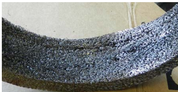
Рис. 5. Внутренняя поверхность пористого образца после 15 часов испытаний
