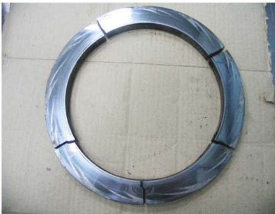
Рис. 6. Разрушившееся кольцо исследуемого уплотнения нагнетателя
