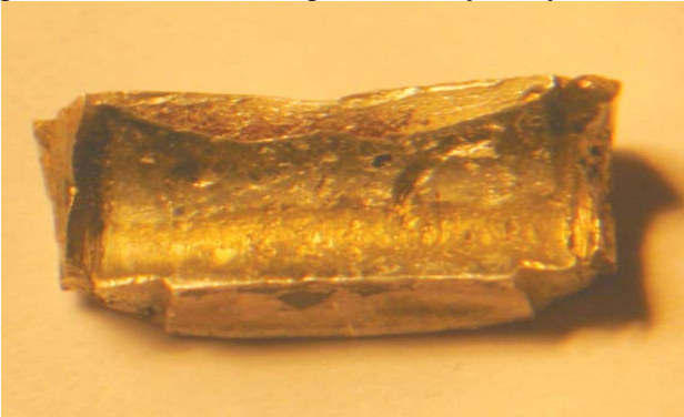
Рис. 3. Повреждённая перемычка сепаратора МРП (обратная сторона)
