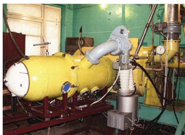
Рис. 4. Общий вид и расположение вакуумных камер на стенде
