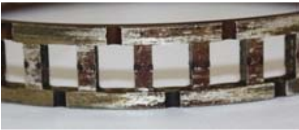
Рис. 6. Сепаратор МРП со следами неравномерного износа
