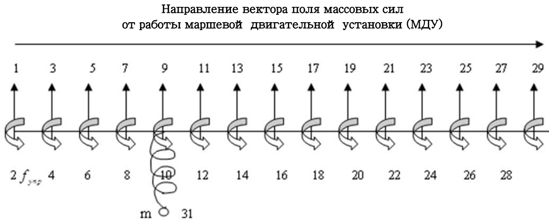
Рис. 2. Упрощённая схема корпуса РН тандемной компоновки с механическим аналогом колеблющейся жидкости в баке
