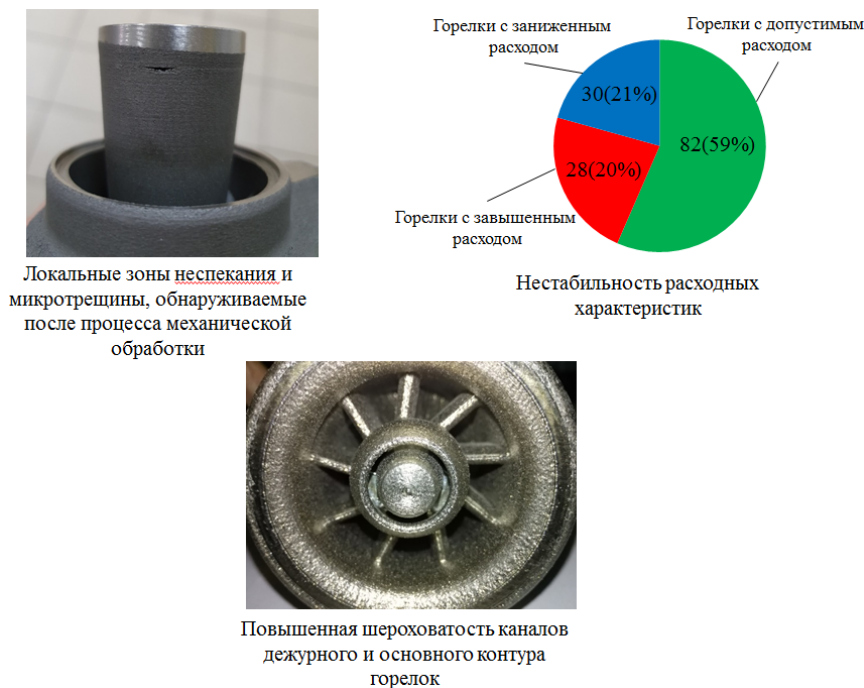
Рис. 4. Типичные недостатки малоэмиссионных горелок, изготовленных с помощью метода СЛС
