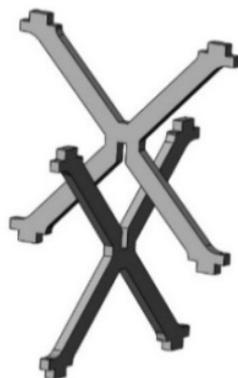
Рис. 2. Создание элементарной ячейки X-образного ферменного заполнителя
