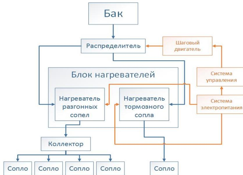
Рис.1. Схема опытной электротермической двигательной установки
