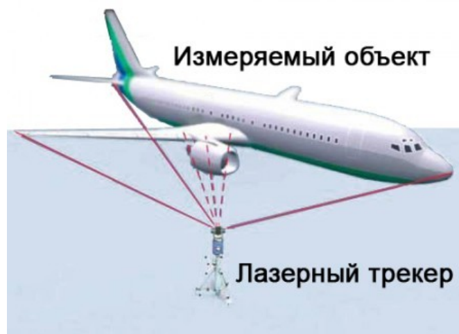
Рис. 2. Контроль геометрии крупногабаритных сборок
