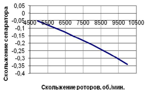
Рис.3. Зависимость проскальзывания от скольжения роторов при n_n = 13067 об/мин
