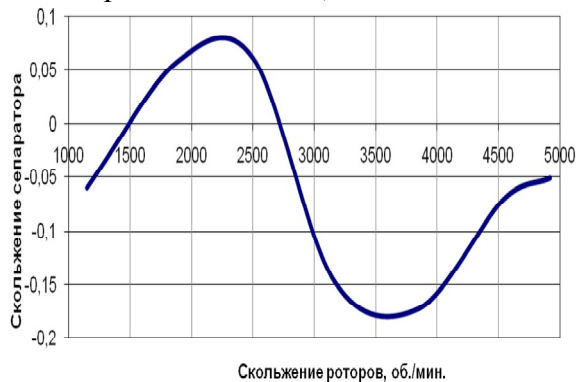
Рис. 4. Зависимость проскальзывания от скольжения роторов при n_6 = 8152 об./мин.
