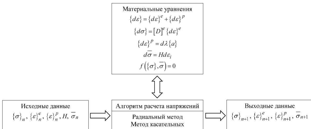
Рис. 3. Определение напряженно-деформированного состояния методом конечных элементов по математической модели материала
