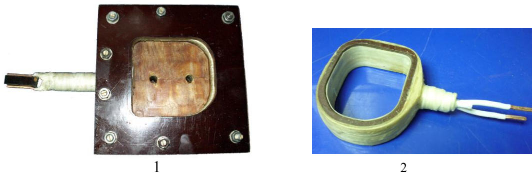
Рис. 3. Внешний вид индуктора для фальцовки (1 - одновитковой индуктор, 2 - четырехвитковой индуктор)
