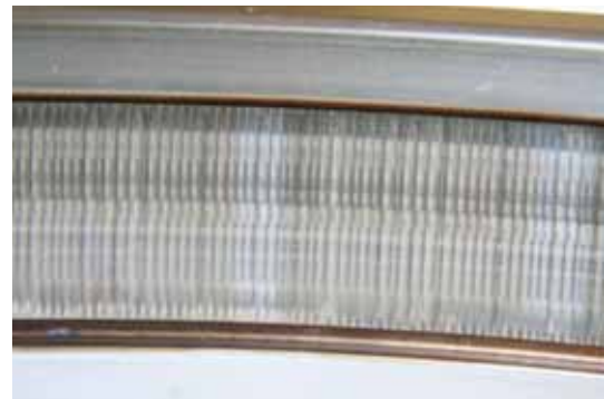
Рис. 5. Наружная обойма заднего РП (НК-37СТ)
