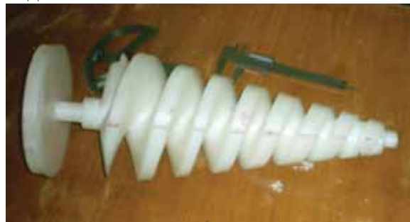
Рис. 2. Модель основного ротора винтовой расширительной машины. Диаметры 160 / 40 мм, угол конусности ротора 20^\circ , длина винтовой части 400 мм, винтовая поверхность в виде двухзаходной резьбы на четыре оборота с шагами 112, 96 и 80 мм
