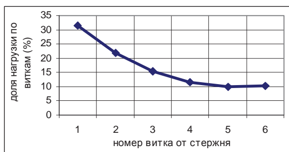
Рис.1. Распределение усилий по виткам точно изготовленной резьбы в статике в процентном отношении к нагрузке на болт:
