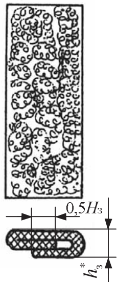
Рис. 2. Схема формирования ленты из коврика
