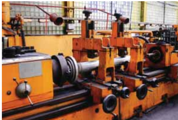
Рис. 13. Обработка вала на специальном станке
