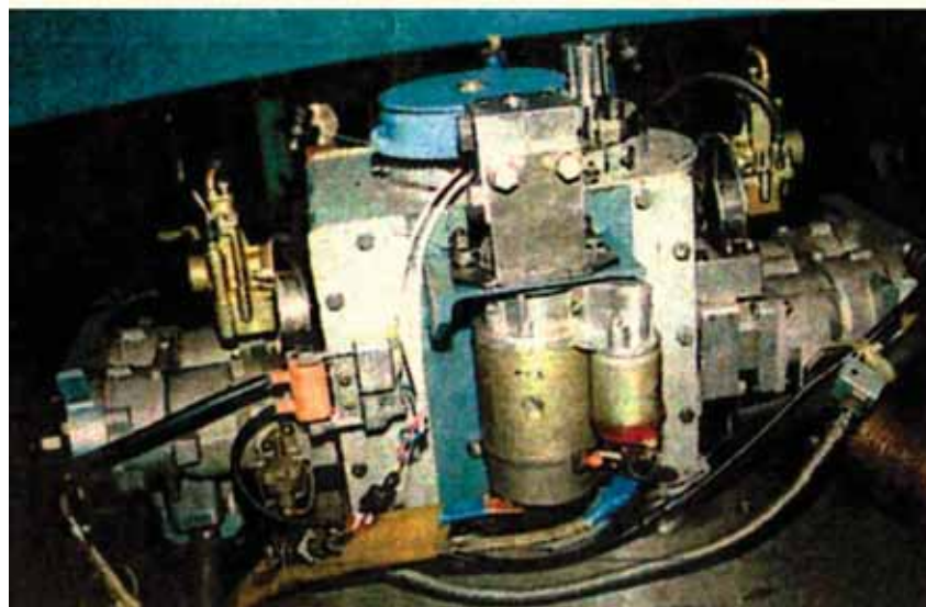
Рис. 11. Опытно–экспериментальный образец двигателя с бесшатунным преобразователем движения поршня, поршневым наддувом воздуха и оппозитным расположением цилиндров
