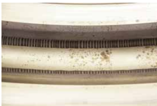
Рис. 6. Беговая дорожка шарикового подшипника (НК-37СТ)
