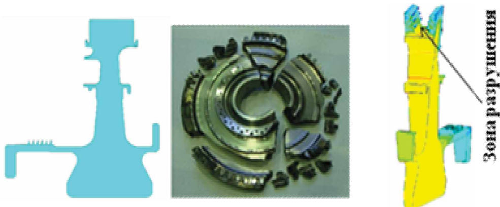
Рис.1. Меридиональное сечение, разрушенный диск и поле напряжений
