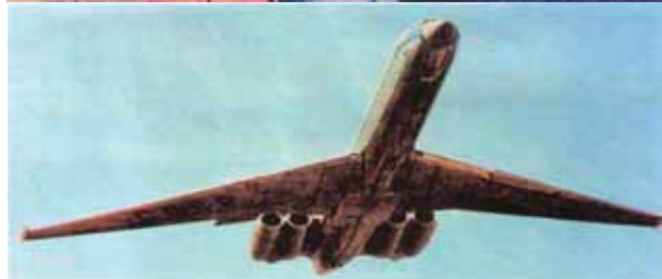
Рис. 2. Двигатель НК-8-4 и самолёт Ил-62
