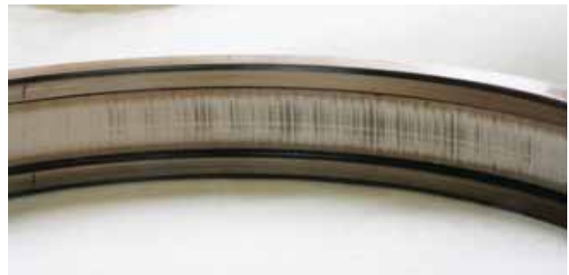
Рис. 3. Наружная обойма переднего РП (НК-37СТ)
