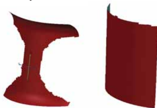
Рис. 1. Пространственные поверхности, снятые в системе «ARAMIS»
