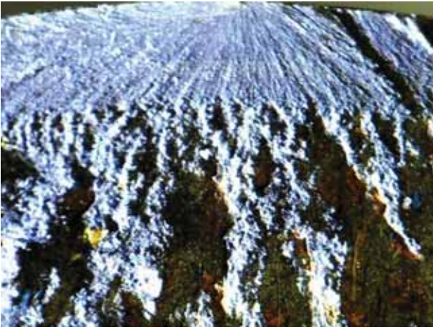
Рис. 1. Область излома стали 40XN, выполненного под углом 15^\circ к обработанной поверхности; увелич. \times 15
