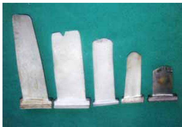
Рис. 8. Заготовки лопаток компрессора НК - 25, изготовленные методом ВСШ
