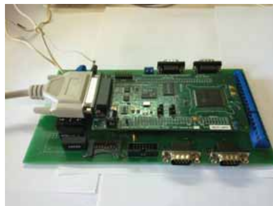
Рис. 9. Система обработки информации в реальном времени на основе цифрового сигнального контроллера TMS320F2812
