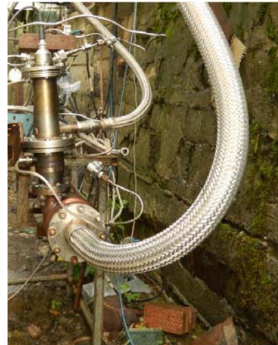
Рис. 7. Газогенератор ГГ-2 с эжектором в сборе
