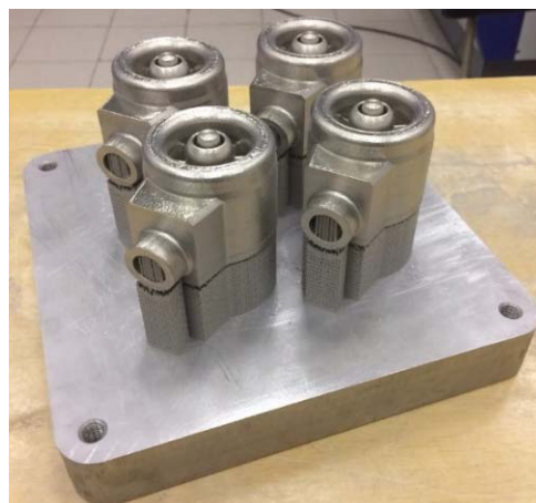
Рис. 4. Партия двухконтурных малоэмиссионных горелок, изготовленных по технологии селективного лазерного сплавления
