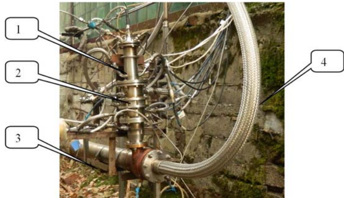
Рис. 1. Газогенератор ГГ-1 с эжектором в сборе: 1 – камера сгорания; 2 – смеситель; 3 – эжектор; 4 – рукав, соединяющий эжектор с барокамерой
