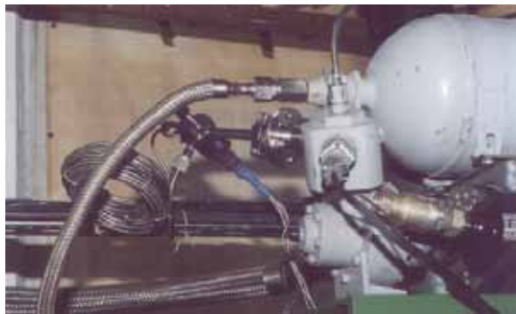
Рис. 7. Узел испытательной камеры стенда с датчиком и опытным акустическим зондом
