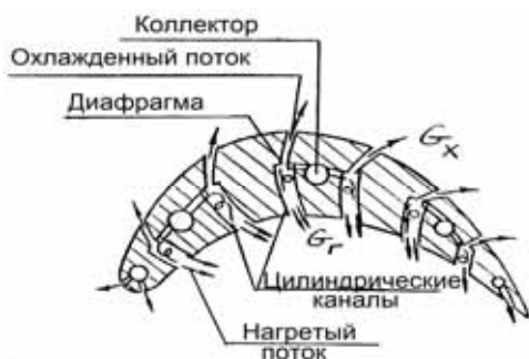
Рис. 1. Рабочая лопатка с вихревыми микроэнергоделителями [1]
