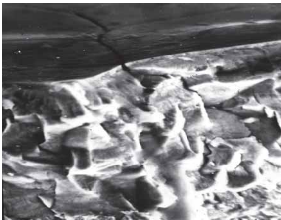
Рис.4. Межзёрное разрушение стандартного хромового покрытия, x2000
