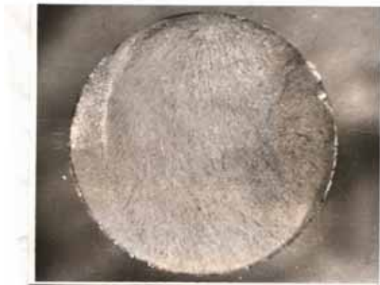
Рис. 4. Усталостный излом упрочненного образца из сплава VT9
