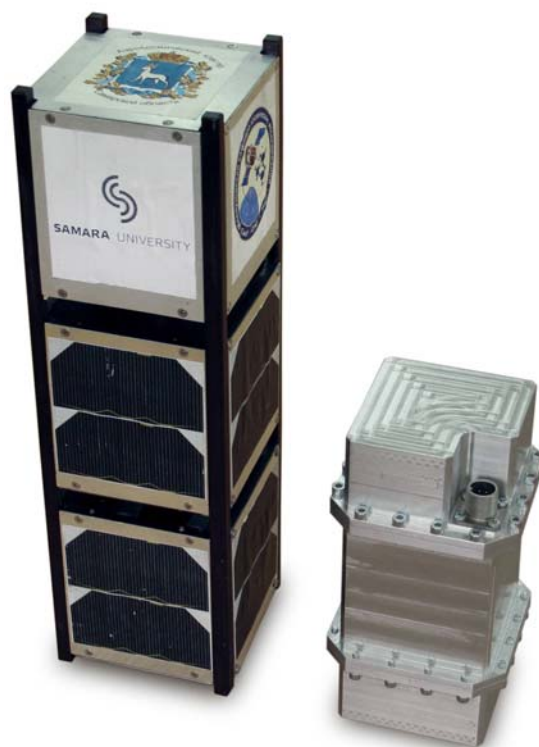
Рис. 2. Наноспутник семейства SamSat и макет герметичного корпуса биомодуля «BiNOM»
