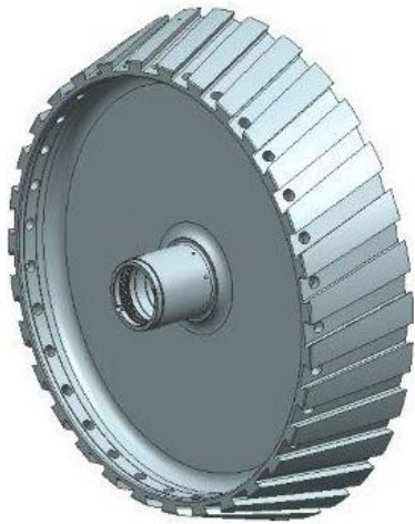
Рис. 1. Модель диска 1-й ступени КНД
