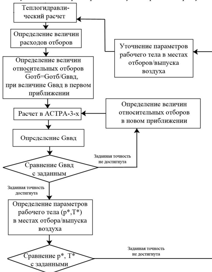
Рис 6. Фрагмент алгоритма определения влияния герметичности уплотнения на параметры эффективности двигателя
