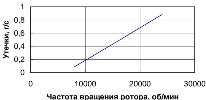
Рис. 5. Расходная характеристика уплотнения
