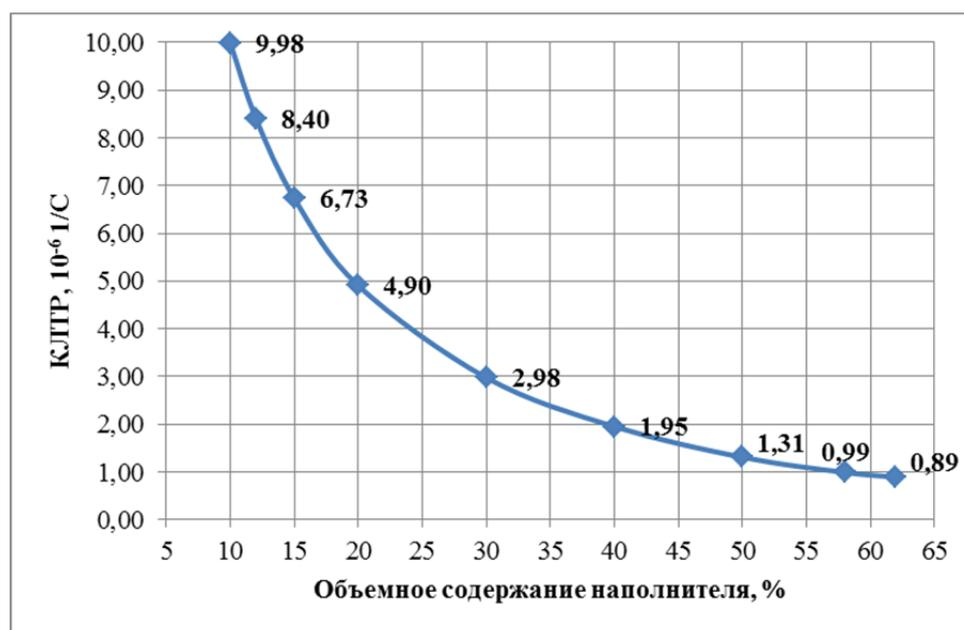
Рис. 3. Зависимость КЛТР от процентного содержания волокна для углепластика на основе ленты ЛУ-П/0,1 и связующего ЭНФБ со схемой армирования  $(0^\circ / +45^\circ / -45^\circ / 90^\circ)_{2n}$
