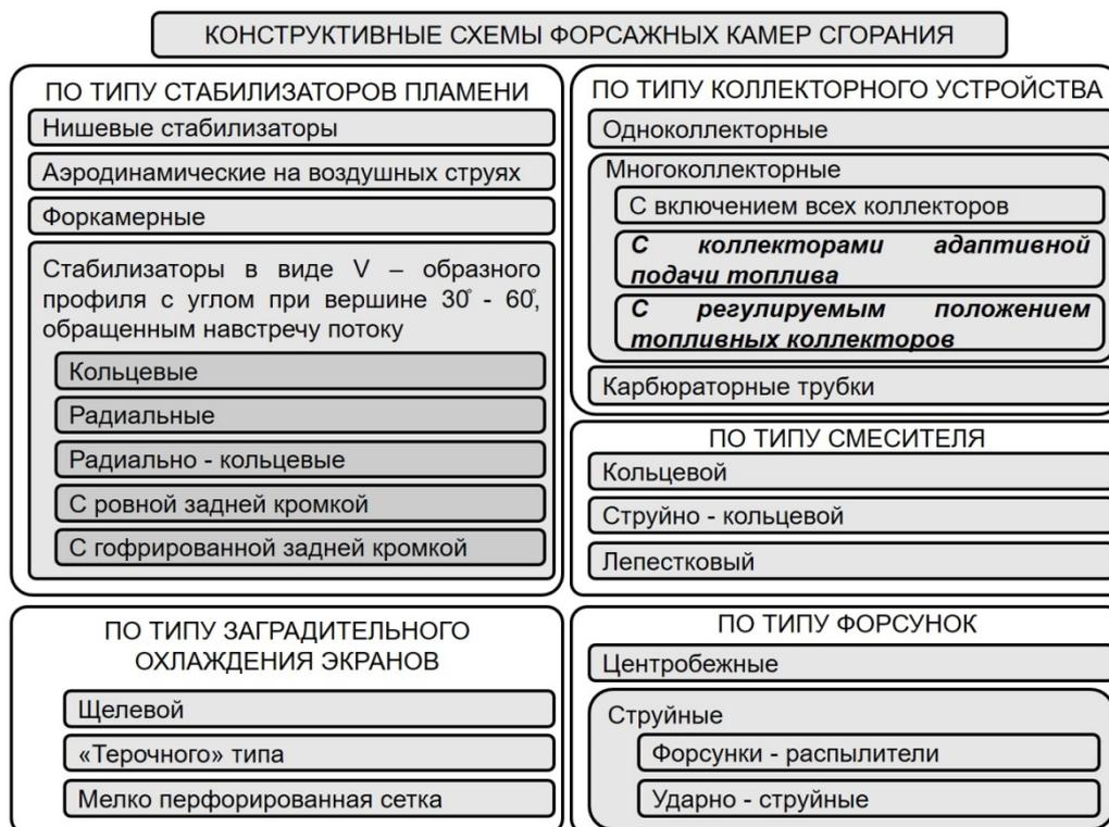
Рис. 1. Классификация конструктивных схем форсажных камер сгорания
