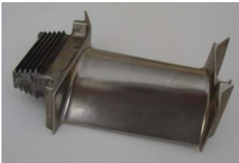
Рис. 1. Лопатка первой ступени турбины
