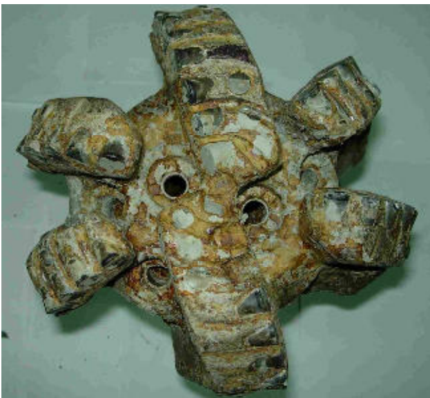
Рис. 2. Отработанное буровое алмазное долото
