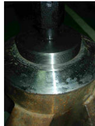
Рис. 3. Разрезанный после сварки корпус долота
