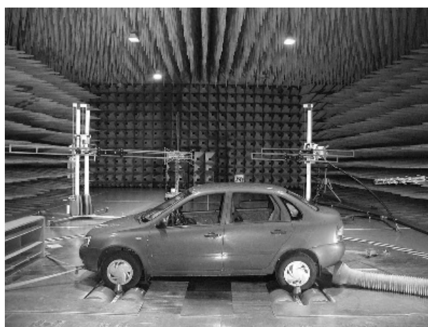
Рис. 2. Испытательная камера лаборатории исследования электромагнитной совместимости ОАО «АВТОВАЗ»
