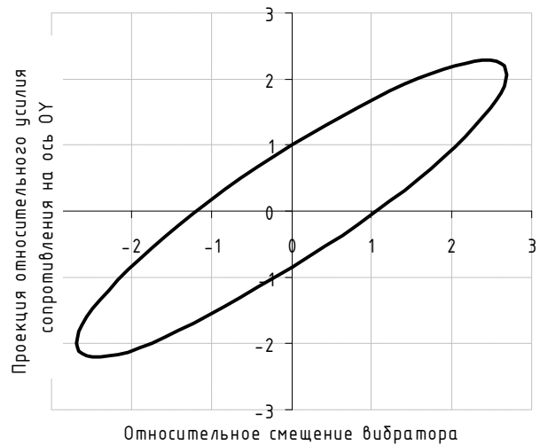
Рис.6. Зависимость относительной силы сопротивления демпфера в проекции на ось OY от амплитуды смещения вибратора в безразмерном виде
