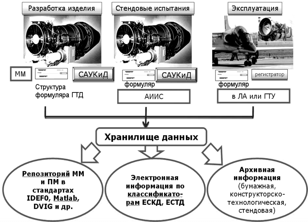
Рис.5. Концептуальная схема информационных потоков в условиях ОКБ и в эксплуатации
