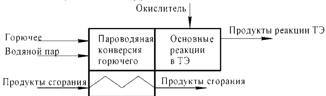
Рис. 4. Схема расчета ТОТЭ
