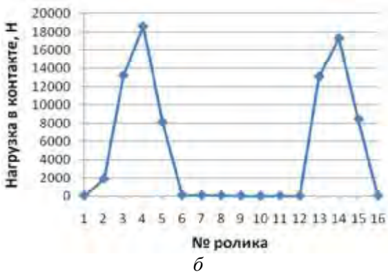
Рис.7. Распределение нагрузки в контактах роликов с внутренним (а) и наружным (б) кольцами с учетом деформаций сжатия внешнего кольца и частоты вращения водила
