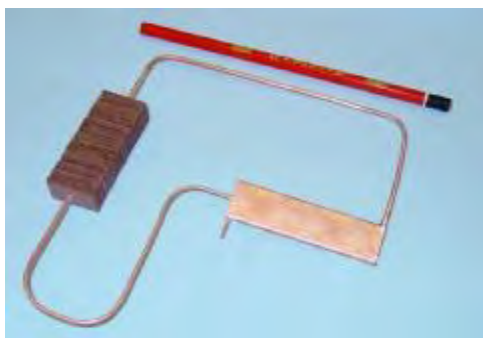
Рис. 8. Миниатюрная контурная тепловая труба Термическое сопротивление: 0,02-0,1 К/Вт
