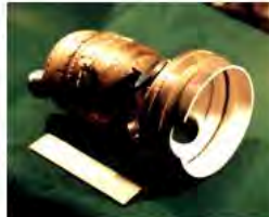
Труба жаровая двигателя НК-36СТ с теплозащитным покрытием.
