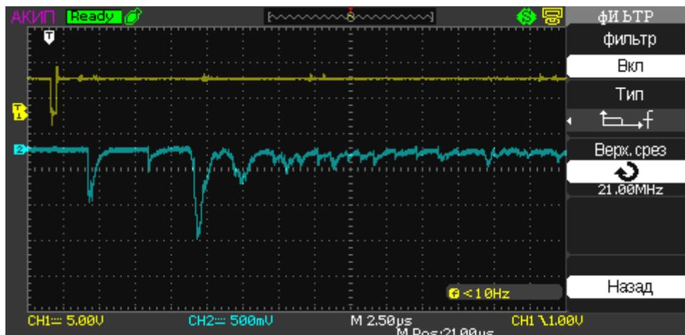
Рис. 5. Осциллограмма ионного тока, равного 95 эВ
