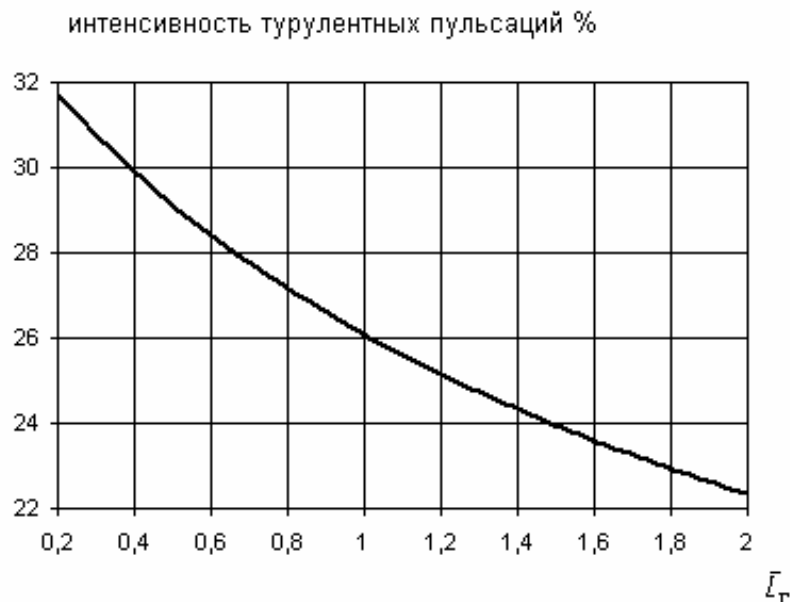
Рис. 3. Влияние на интенсивность турбулентных пульсаций длины газосборника жаровой трубы камеры сгорания
