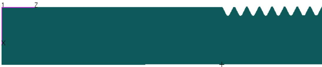
Рис. 2. Конечно-элементная модель образца с резьбовой частью
