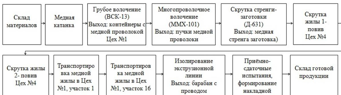
Рис. 1. Цепочка изготовления провода FLRY-25-С
