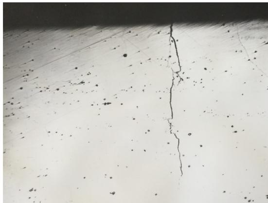
Рис. 2. Транскристаллитно развивающиеся мелкие трещины на втором корпусе
