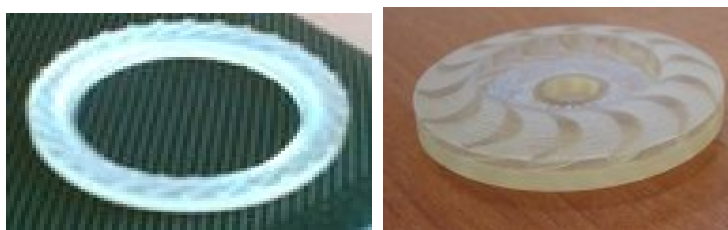
Рис. 1. Образцы центробежного микротурбинного привода: сопловой аппарат (слева) и цельновыращенное закрытое рабочее колесо (справа)
