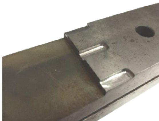
Рис.2. Пазы, вырезанные во фрагменте пресс-формы
