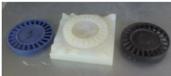
Рис. 13. Создание металлической крыльчатки для микроГТД (слева направо): восковка, силиконовая форма, металлическая отливка
