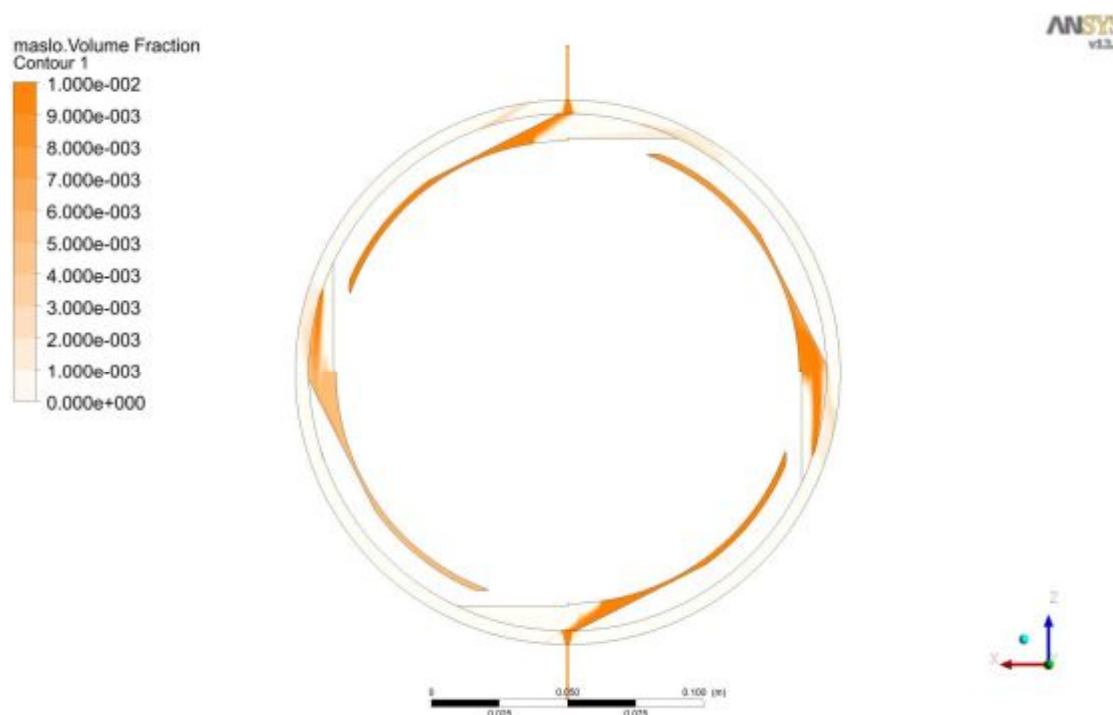
Рис. 4. Распределение масла по каналам маслозахватного кольца
