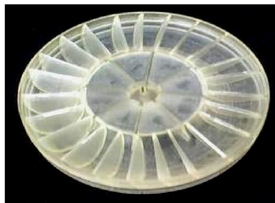
Рис. 5. Образец крыльчатки лопастного насоса для гидродинамических испытаний
