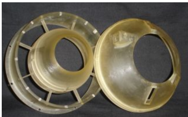
Рис. 4. Экспериментальный образец горелки с прозрачными окнами в наружной части для PIV-исследования потока внутренней зоны
