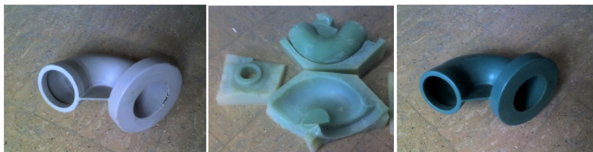
Рис. 12. Создание газохода для ракетного двигателя: а - мастер-модель (сборка из стереолитографических прототипов); б - силиконовая форма; в - восковка для литья металла
