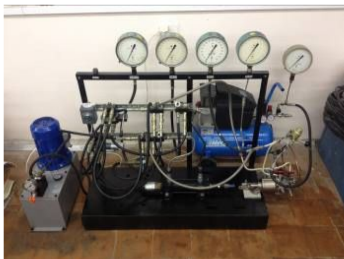
Рис. 6. Экспериментальная установка для исследования статических и динамических характеристик АУП ГТД
