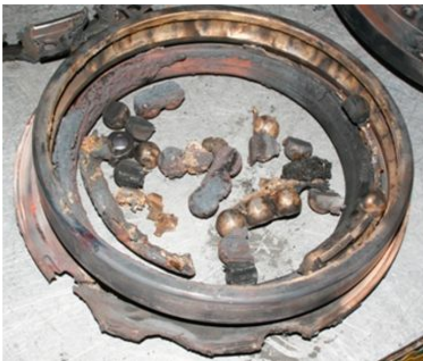
Рис. 1. Фрагменты разрушенного подшипника
