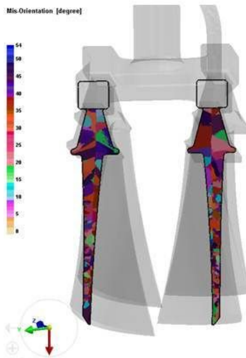
Рис. 10. Направление роста зёрен внутри отливки
