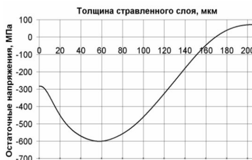
Рис. 3. Эпюра распределения остаточных напряжений
