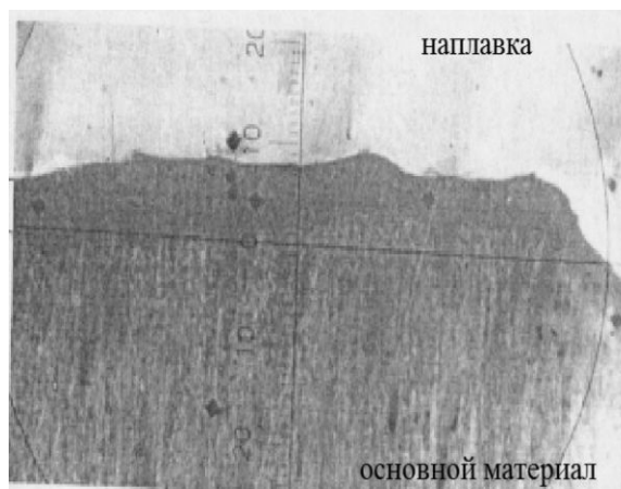
Рис.4. Микроструктура зоны «наплавка-основной материал» образца № 2
