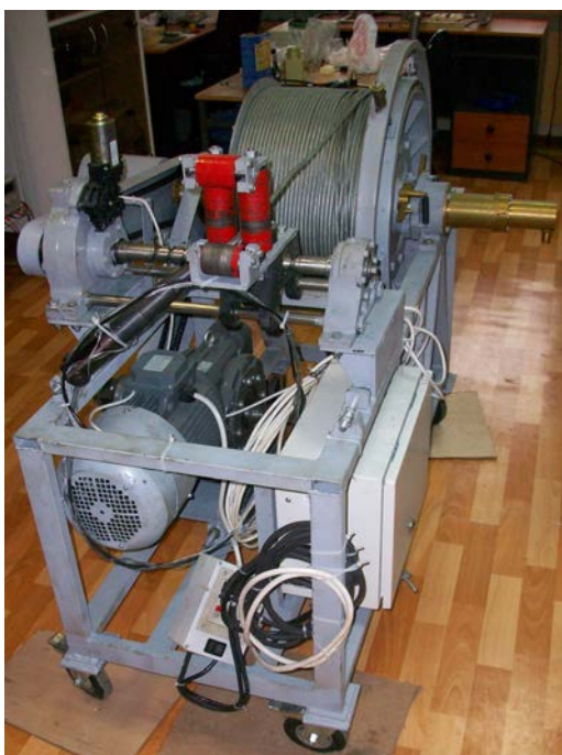
Рис. 2. Лебёдка морская электрическая
