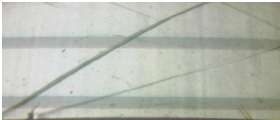
Рис. 4. Теневая картина отрывного течения ( M_0=2.75 ) при высотах ребра: слева – 4 мм, справа – 8 мм
