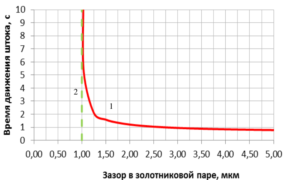
Рис. 7. Зависимость времени движения исполнительного штока от зазора в золотниковой паре ручного управления при давлении в системе 4,5 МПа: 1 – зависимость времени движения штока от зазора в паре; 2 – зазор, при котором происходит заклинивание пары
