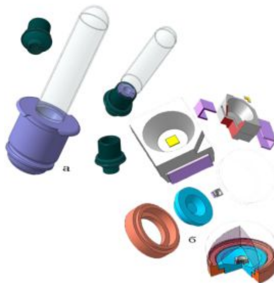
Рис. 2. Два источника света лобового прожектора железнодорожного локомотива: а – лампа накаливания ПЖ (ТУ 16-87 ИМФР 675000.003 ТУ); б – светодиод с вторичной оптикой
