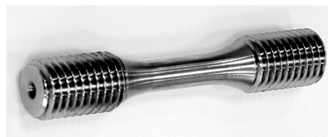
Рис. 1. Опытные стандартные образцы из сплава ЭП609Ш для испытаний на МЦУ
