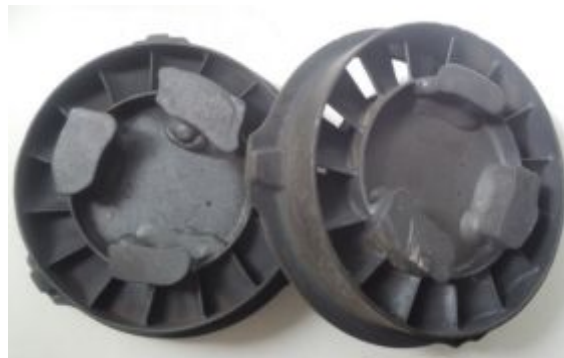
Рис. 6. Статор турбины малоразмерного газотурбинного двигателя с литниково – питающей системой
