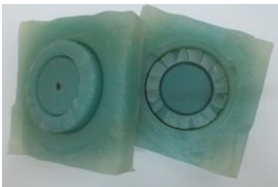
Рис. 4. Силиконовая форма ротора турбины
