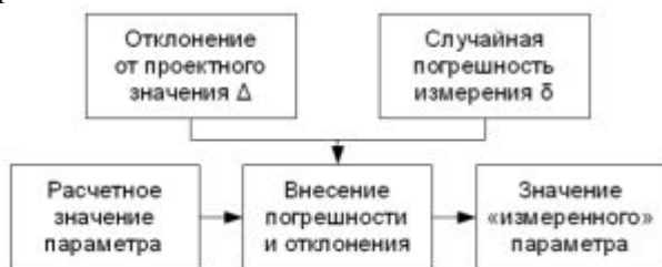
Рис. 2. Схема моделирования погрешностей измерений и отклонений
