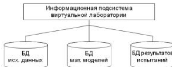
Рис. 3. Структура информационной подсистемы виртуальной лаборатории испытаний ГТД
