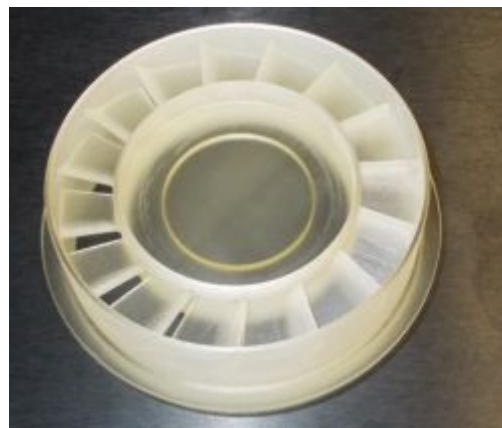
Рис. 3. Мастер – модель статора турбины малоразмерного газотурбинного двигателя
