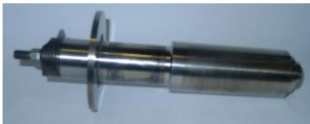
Рис. 2. Ротор электрокомпрессора на постоянных магнитах без рабочего колеса центробежного компрессора
