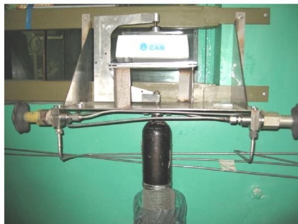
Рис. 6. Общий вид устройства для измерения расхода компонента топлива
