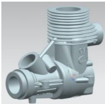
Рис. 1. 3D модель картера двигателя внутреннего сгорания
