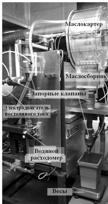
Рис. 1. Испытательная установка и коммуникации стенда
