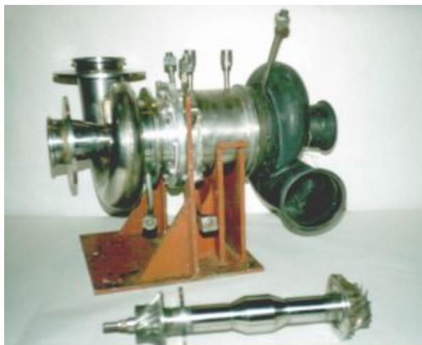
Рис. 1. Блок и ротор турбогенератора-компрессора замкнутой газотурбинной установки
