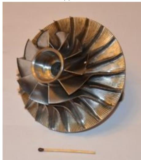
Рис. 1. Исследуемое центробежное колесо компрессора диаметром 90 мм
