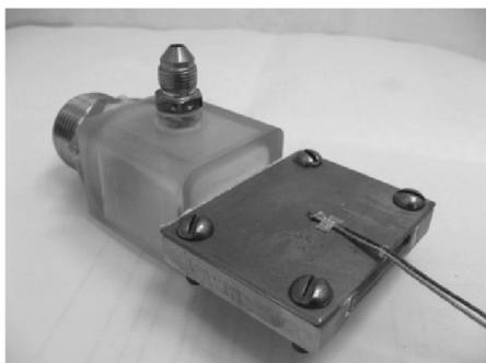
Рис. 1. Экспериментальный участок для исследования теплообмена в плоском канале с установленной пластиной
