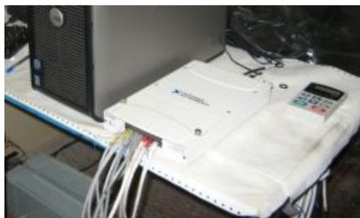
Рис. 5. Плата системы сбора и обработки информации М6225 фирмы National Instruments (США) и пульт управления частотным преобразователем
