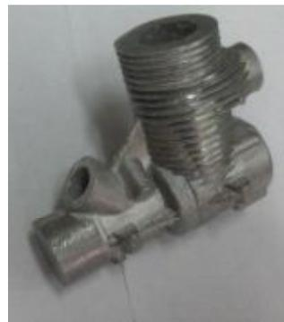
Рис. 5. Отливка картера
