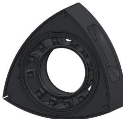
Рис. 16. Трёхмерная модель ротора
