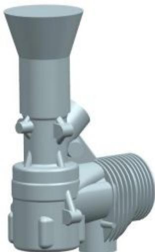
Рис. 2. 3D-модель заготовки с литниковой системой
