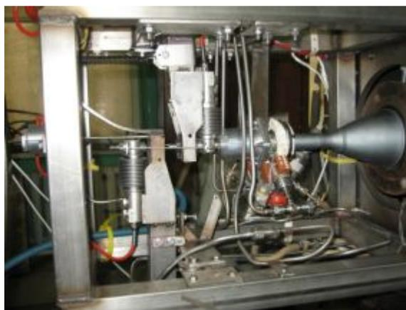
Рис. 3. Общий вид тягоизмерительного устройства с ЖРДМТ
