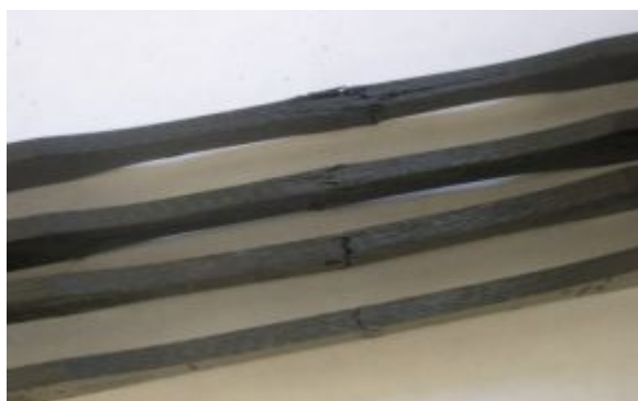
Рис. 27. Фотографии разрушенных образцов с различным содержанием дефектных слоёв ткани (снизу - вверх: 50%, 33,3%, 16,6%, 0% повреждённых волокон)
