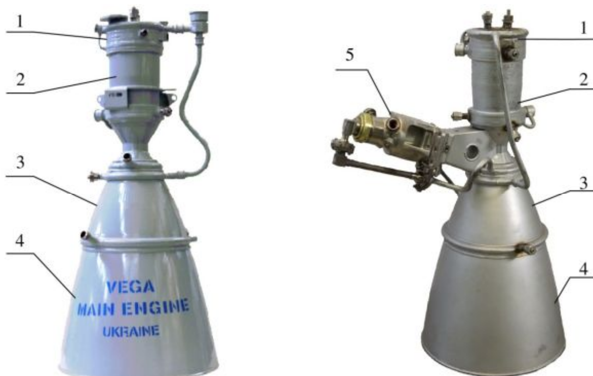
Рис. 1. Камера БМД (слева) и её прототип - камера двигателя РД869 (справа): 1 – форсуночная головка, 2 – секция горючего, 3 – секция окислителя, 4 – радиационно-охлаждаемый сопловой насадок, 5 – узел подвода
