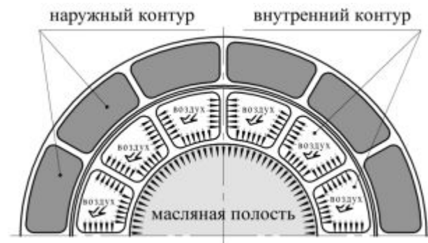
Рис. 2. Процесс теплопередачи через стенки опоры ГТД
