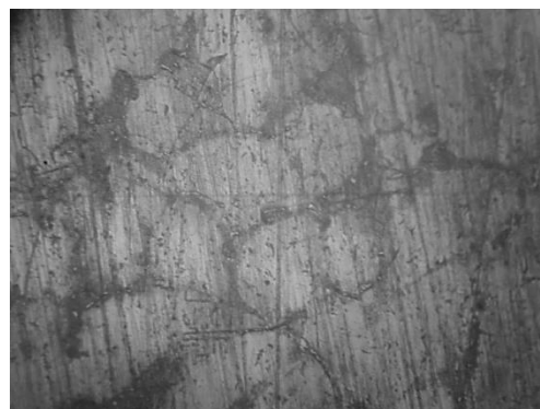
Рис. 6. Микроструктура сплава ЖС6Ф (X250)
