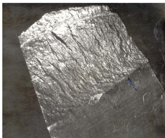
Рис. 1. Фрагмент излома замковой части диска турбины
