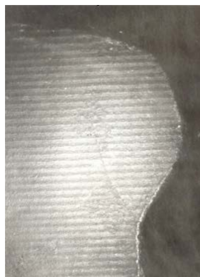
Рис. 2. Трещина в пазу замковой части диска турбины ГПА ГТК-10-4 из стали 20Х12ВНМФ со стороны входного торца. \times 10
