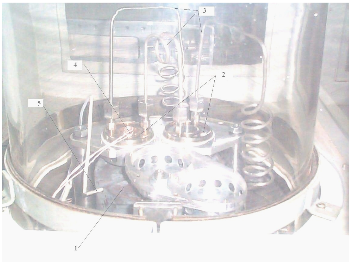
Рис. 2. Устройство исследования динамики конденсированных продуктов: 1 – блок медный; 2 – охлаждаемые держатели пьезорезонансных датчиков; 3 – трубки подвода охлаждающей жидкости; 4 – пьезорезонансный датчик массы; 5 – хромель-копелевая термопара в керамическом изоляторе
