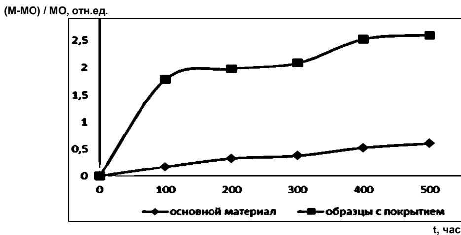
Рис. 5. Относительное изменение массы образцов из сплава ЖС6Ф до и после нанесения интерметаллического подслоя «Ni-Co-Cr-Al-Y» от времени изотермической выдержки
