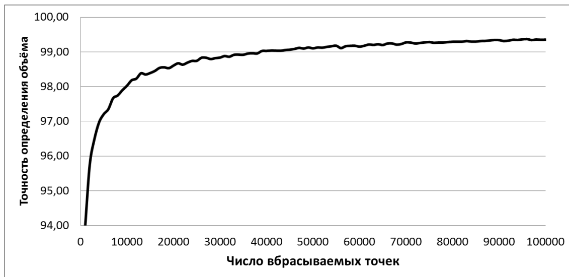
Рис. 3. Зависимость точности определения объёма ячейки Вигнера-Зейтца от количества вбрасываемых точек
