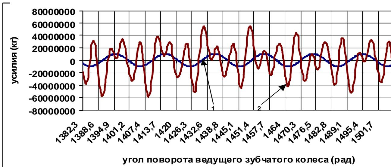
Рис.10. Усилия в зубьях зубчатых колес и в опорах ведомого зубчатого колеса при одном штифте в соединении в процессе установившегося движения. Частота вращения ведущего зубчатого колеса 14250 1/мин; зацепление зубьев беззазорное, коэффициент демпфирования в упругой системе  $\lambda=4000 \text{ кг*сек/см}$
