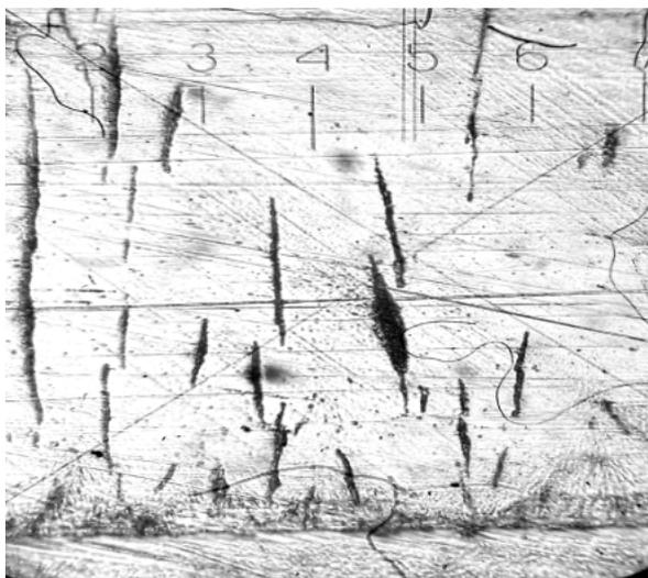
Рис. 4. Характерные микродефекты покрытия (цена деления прибора 30 мкм)
