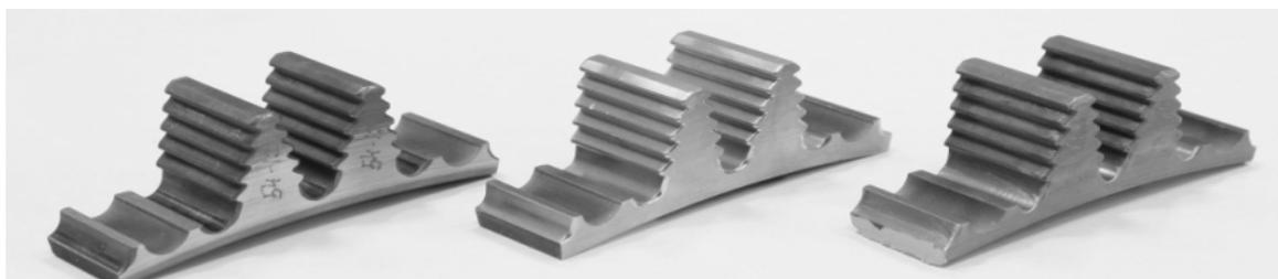
Рис.1. Опытные образцы замок-елка
