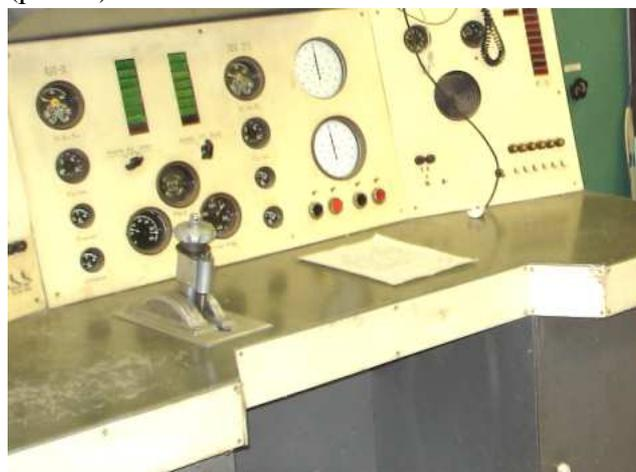
Рис. 4. РУД с дистанционным управлением электропривода
