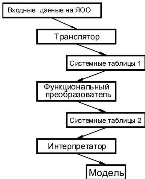
Рис. 6. Схема создания МЛТ в САПМ
