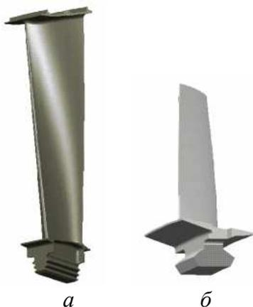
Рис. 1. Турбинная (а) и компрессорная (б) лопатки
