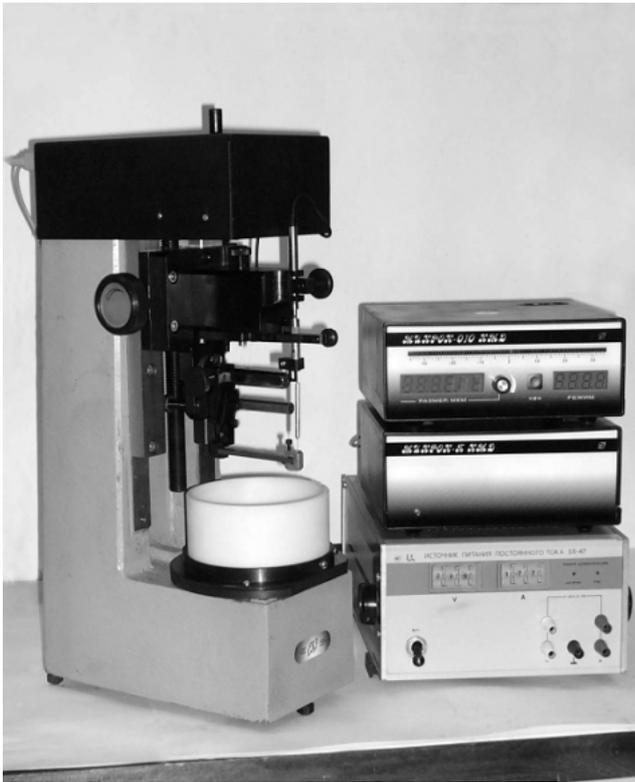
Рис.3. Установка для автоматизированного определения остаточных напряжений
