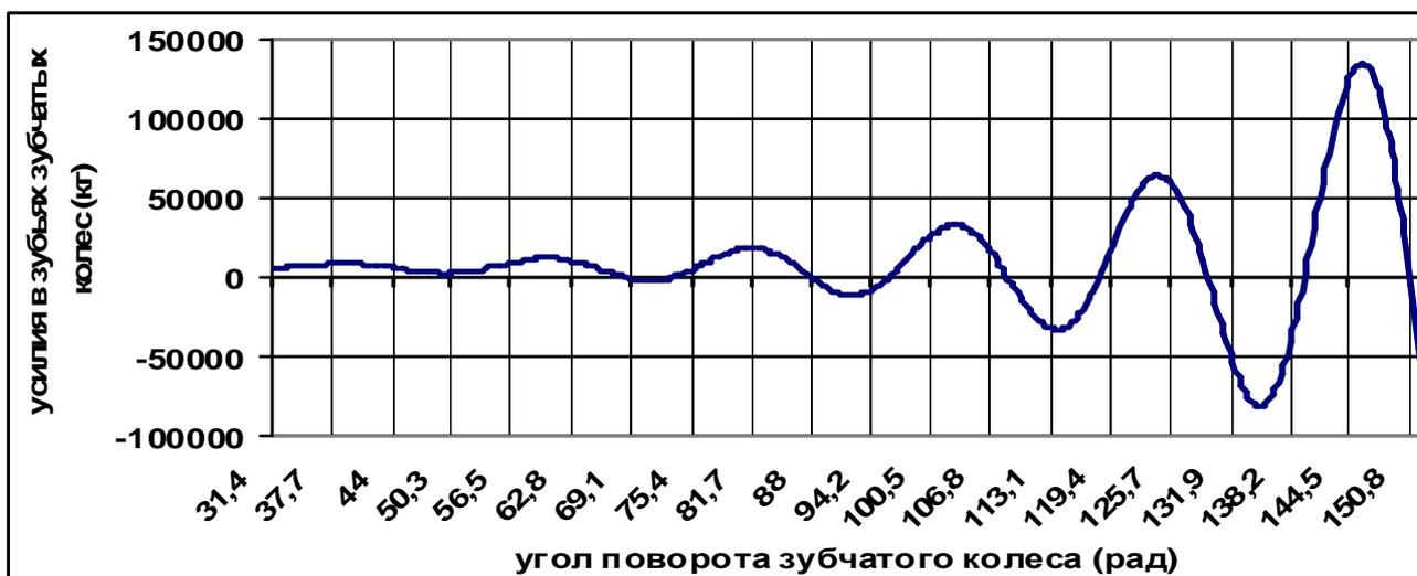
Рис. 8. Усилия в зубьях зубчатых колес при одном штифте в соединении в начале движения. Частота вращения ведущего зубчатого колеса 14250 об/мин. Коэффициент демпфирования в упругой системе  $\lambda=4000$  кг\*сек/см
