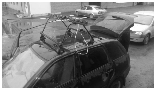
Рис. 2. АФУ МПРЛК, установленное на автомобиле
