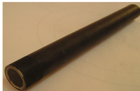
Рис. 5. Высокотемпературный наконечник волноводного ПП с кварцевым стеклом
