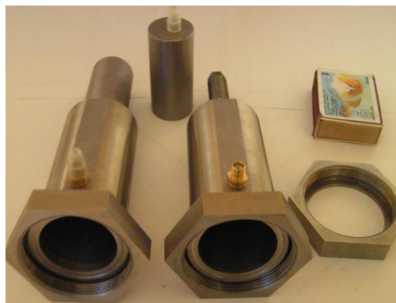
Рис. 2. Волноводно-коаксиальный переход на рабочую частоту 6 ГГц
