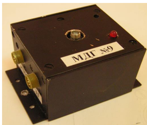
Рис. 1. Внешний вид термостатированного генераторного модуля
