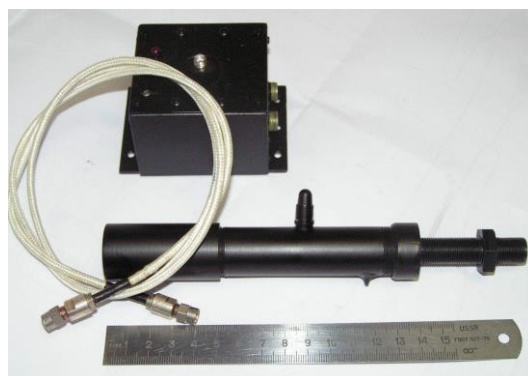
Рис. 6. Внешний вид термостатированного генераторного модуля и волноводной части ПП для использования в ГТД
