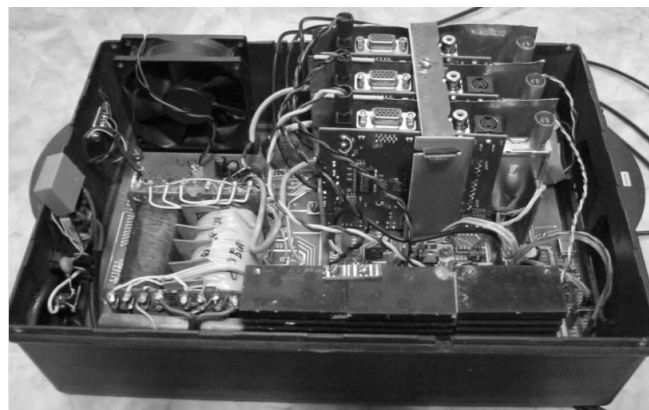
Рис. 3. Внешний вид трёхканального приёмника
