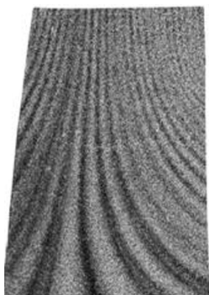
Рис. 10. Определение нулевой полосы на спекл-интерферограмме лопатки 9-й ступени компрессора в случае, когда нижняя часть лопатки недоступна для наблюдения
