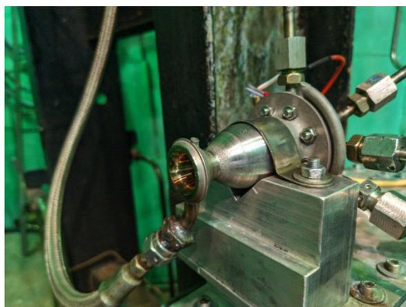
Рис. 1. Функциональный макет камеры на исследовательском стенде
