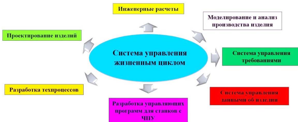
Рис. 1. Структура системы управления жизненным циклом
