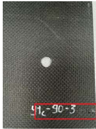
Рис. 12. Разрушение образца за пределами зоны отверстия
