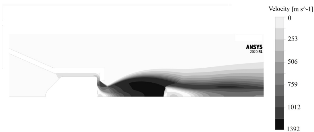
Рис. 6. Эпюра скоростей течения рабочего тела в объёме сопла по результатам численного моделирования (давление окружающей среды p_n = 50000 Па)
