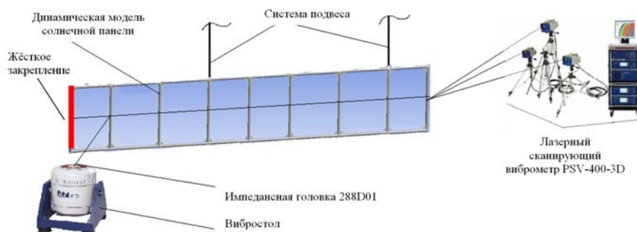
Рис. 3. Схема установки для испытаний солнечной панели космического аппарата
