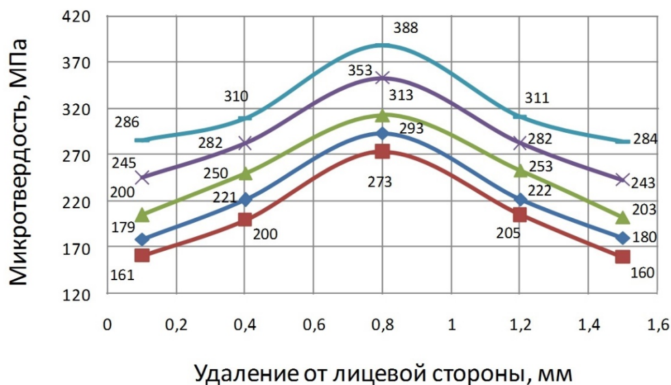
Рис. 2. Изменение микротвёрдости по толщине образцов из углепластика, отверждённых при разных температурах: ■ – 100°C ; ◆ – 120°C ; ▲ – 130°C ; × – 140°C ; — – 145°C
