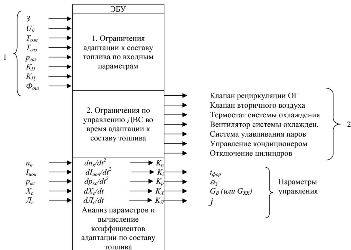
Рис. 1. Принципиальная схема алгоритма адаптации к составу газового топлива с максимальным числом параметров измерения и управления
