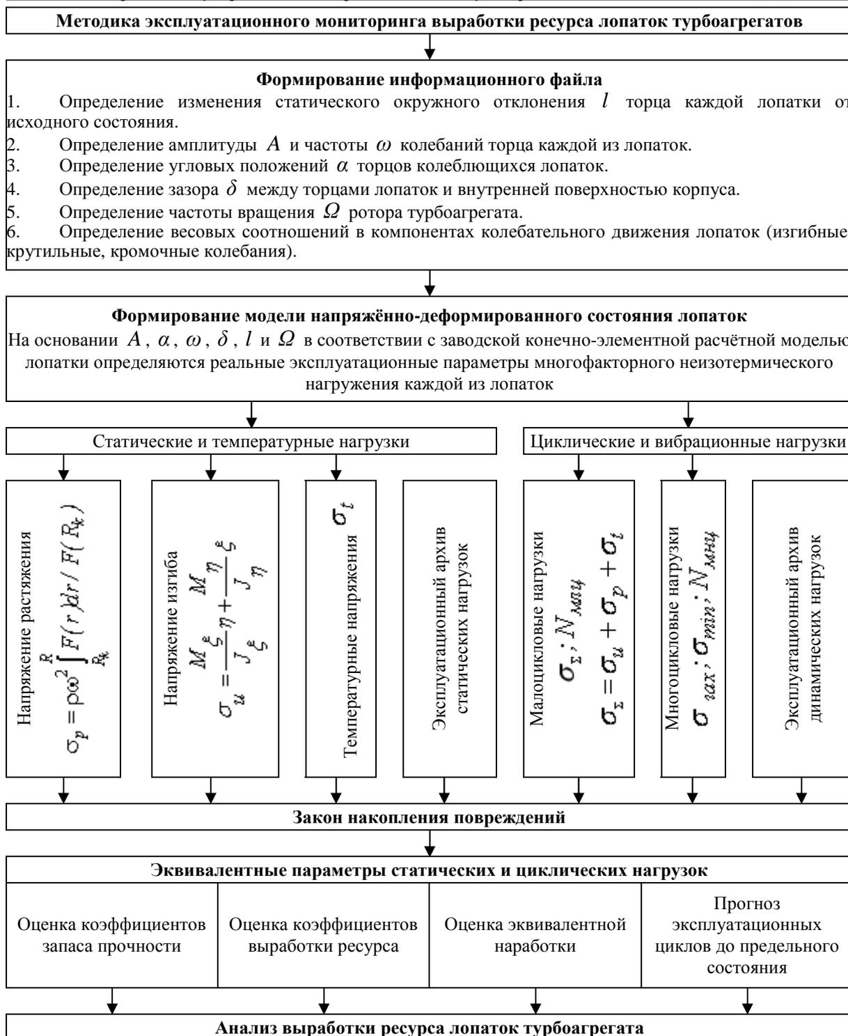
Рис. 1. Алгоритм эксплуатационного мониторинга выработки ресурса лопаток турбоагрегатов
