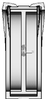
Рис. 2. Модель шарикового подшипника 35-2310118ЕЗС1 с непривулканизированным резиновым амортизатором на наружном кольце подшипника
