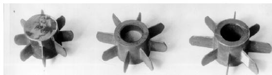
Рис. 6 Образцы дисков с лопатками, отштампованные по трём схемам
